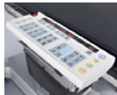
Die Fernbedieneinheit ermöglicht die Steuerung des C-Bogens im sterilen Bereich
