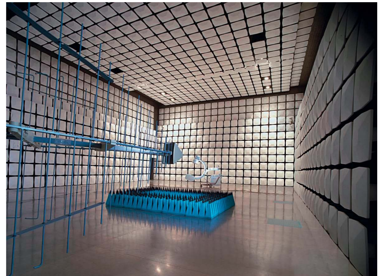
Blick in die Absorberhalle, die die zur Produktprüfung erforderliche elektromagnetisch „neutrale“ Umgebung zur Verfügung stellt. Mit der gezeigten Prüfeinrichtung kann die Störfestigkeit gegen elektromagnetische Felder (z.B. Rundfunk, Fernsehen, Mobilfunk etc.) beurteilt werden.
